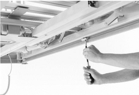
Im Lieferumfang sind ein Metallwinkel und zwei Kreuzschlitzschrauben (4x13) vorhanden. Dieser Winkel wird an der Unterseite in der Mitte des festen Seitenteils mit der Seitenwange verschraubt, damit es keine Quetschstelle zwischen diesen Elementen gibt.
