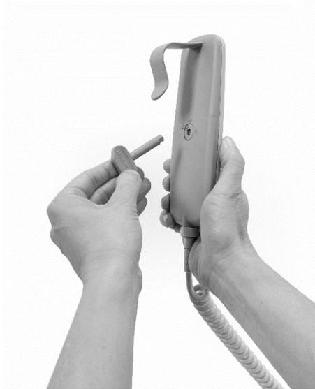
Jetzt müssen Sie den Handschalter mit Hilfe des Schlüssels auf der Rückseite entriegeln, um alle Funktionen nutzen zu können.
