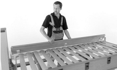
Hängen Sie nun die Seitenwangen ein. Schrauben Sie diese allerdings noch nicht fest. Die Seitenwange mit den Türbeschlägen bitte an die Seite montieren, an der sich später die Türöffnung befinden soll.
