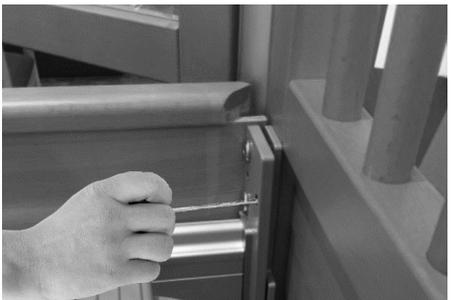
Um die Höhentoleranzen der Türen auszugleichen können an der Lasche am Endstück die Gewindestifte eingedreht werden. Falls die 6 Schrauben schon zu fest sind, diese leicht lösen.
