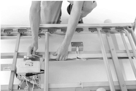
Anschließend können Sie das Netzkabel ebenfalls mit der Steuerung verbinden.
