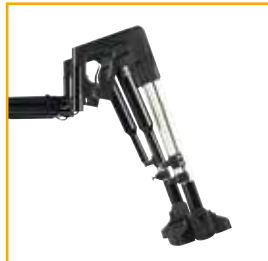
Elektrische lengte compenserende beensteunen, wegzwenkbaar. Onderbeenlengte 350 - 510 mm. Kniehoek 0 - 70°.
