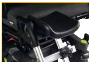
Amputatiesteun Breedte: 180 mm Hoogte: 230 mm Diepte: 35 mm
