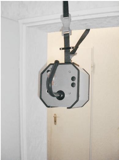
Zu Ihrer Sicherheit sind Pocket-Lift und Pocket-Umsetzlift mit einer Not-Aus-Taste und einer mechanischen Notabsenkung ausgestattet.
