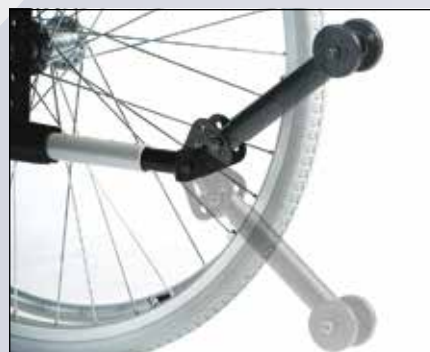
Naar boven wegzwenkbare anti-tip voorziening.
