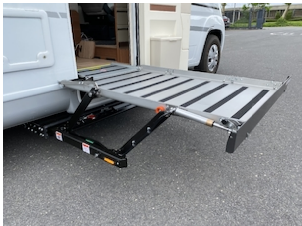
De parallellogramvormige hefarmen garanderen superieure stabiliteit
