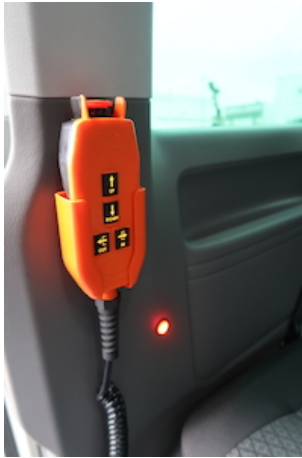
Makkelijke 4-knops afstandsbediening voor de 4 functies: uitschuiven / dalen / stijgen / inschuiven
