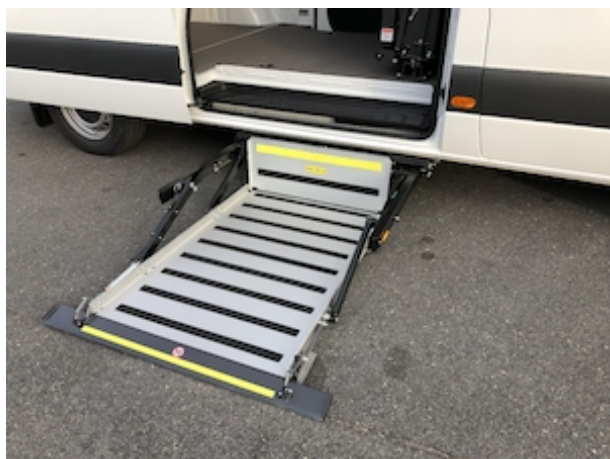
Robuust 1-delig platform met een minimum aan bewegende delen. Beperkt onderhoud en maximale bedrijfszekerheid
