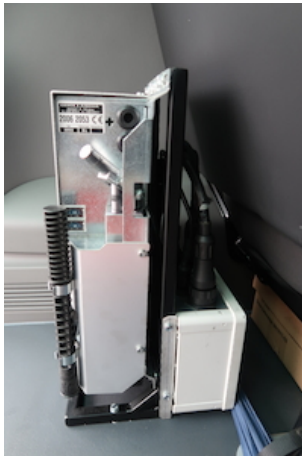
Compacte hydraulische groep in 2 delen (hydraulisch & electrisch apart) geschikt voor montage in de kleinste voertuigen
