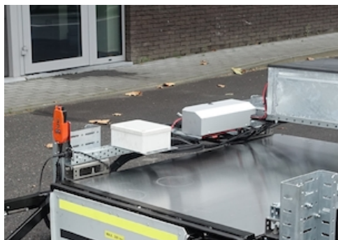
OWH007.0 - Hydraulische groep & elektra gescheiden
