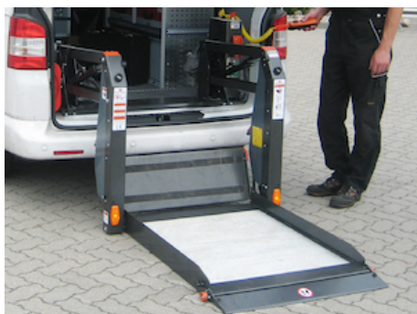
OWP001 - Overrijdplaat op platform gemonteerd
