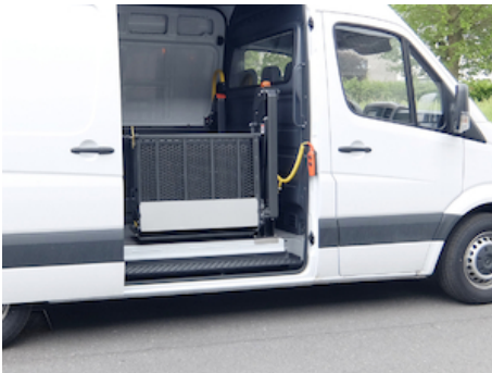
Optie OWU007 = vast frame met horizontaal vouwbaar platform
