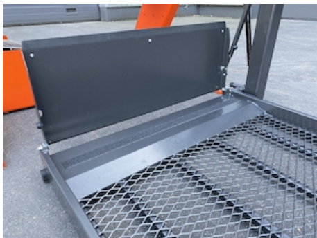
Automatische overrijdplaat + voetbeveiliging + afrolbeveiliging aan de voorzijde van het platform
