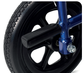
voetpedaal om de stoel makkelijk te kantelen
