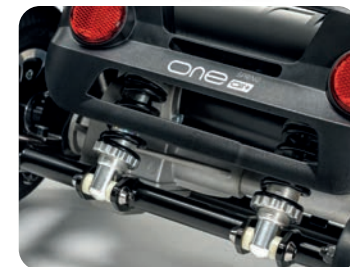
Schokdempers op de wielen en vering onderaan de stoel zorgen voor een aangename rijgevoel.
