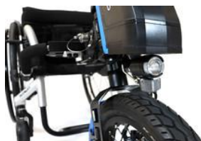
LED-lamp, spatbord en schijfrem
