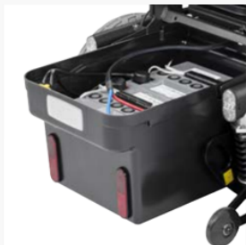
Onderhoudsvriendelijk: eenvoudig accuonderhoud dankzij uittrekbare accubox
