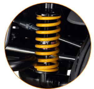
Telescopische schokdempers aan de achterzijde
