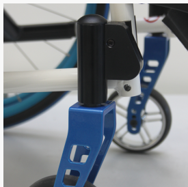
Inclinaison de l'assise jusqu'à 12° pour des réglages précis
