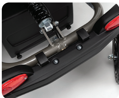
Roterende as voor ultieme stabiliteit
