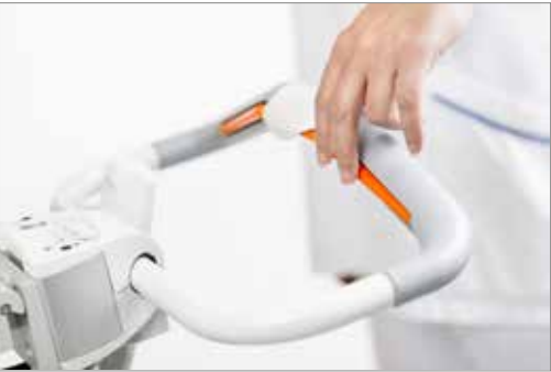
De ergonomische hendel is voorzien van intuïtieve bediening die elke beweging waarneemt. Door zacht te duwen gaat de EvaDrive vooruit en door de EvaDrive licht naar je toe te trekken draait de EvaDrive. De hendel herkent al uw gewenste bewegingen. De EvaDrive gaat in elke richting door subtiele vingerbewegingen. De hendel is ergonomisch en verstelbaar in hoogte. Daarnaast zorgt een veiligheidsschakelaar ervoor dat ongewenste bewegingen voorkomen worden.
