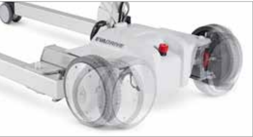
De achterenwielen draaien in elk richting door gebruik te maken van de bedieningshendel. De EvaDrive manoeuvreert in nauwe ruimtes door de zijdelingse beweging van de wielen.
